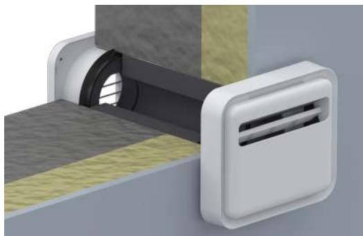
L'élément régulateur constitué d'un volet mobile assure un débit constant sur une plage de pression comprise entre 20 et 100 Pa.
