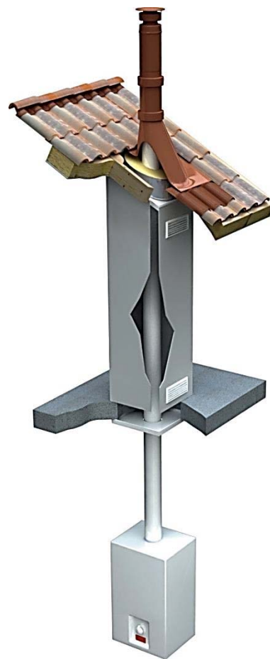
Figure 4C : Etage plafond rampant
