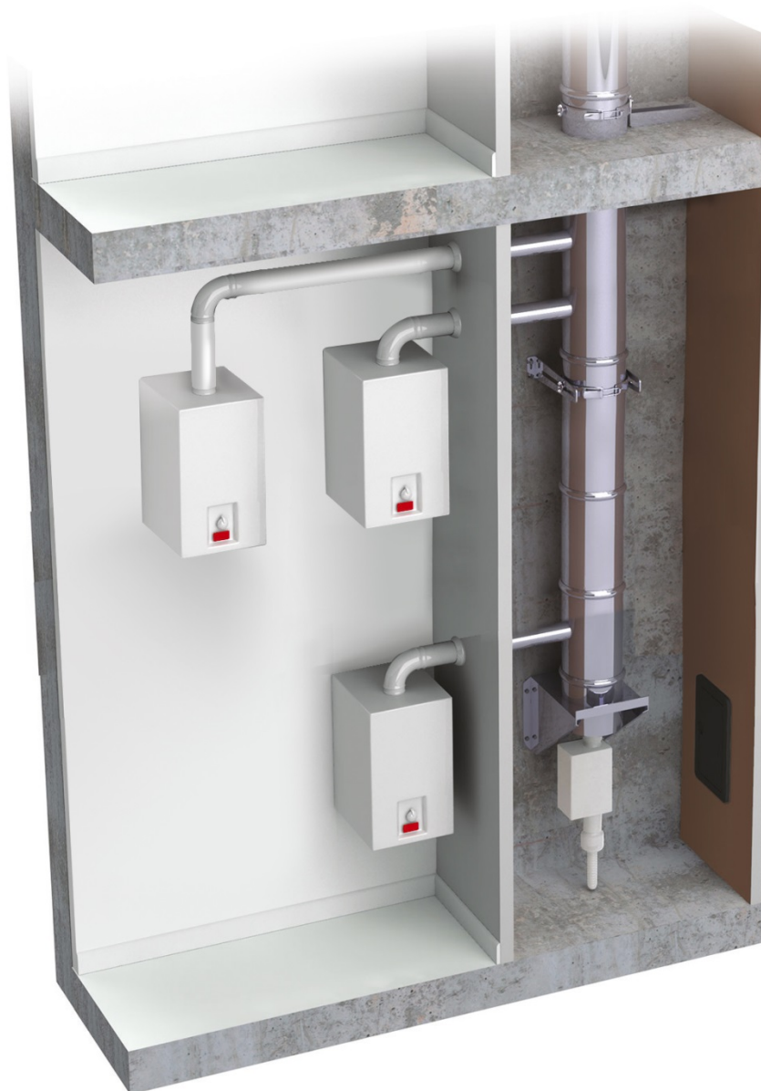
Figure 7 - Principe du système Apollo 3CEp Concentrique dans une Alvéole Technique Gaz
