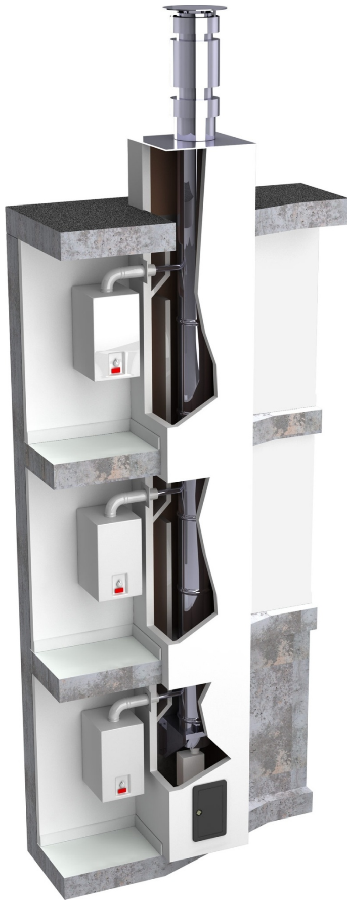
Figure 5 - Principe du système Apollo 3CEp SPI à l'intérieur d'un conduit existant
