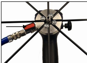
Abb. 14: Absperrhahn Druckluft geöffnet
