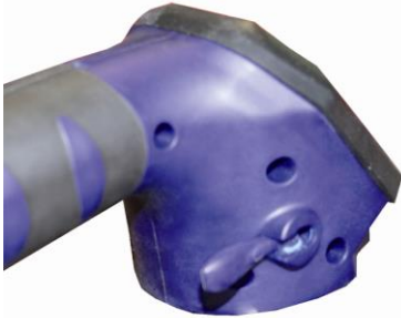
Imm. 35: posizione verticale della leva – protezione per il trasporto
