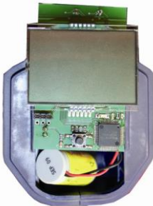
Fig. 68: Remplacement de la pile
