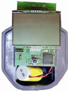
Imm. 51: vano pile
