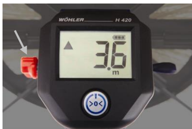
Imm. 44: Vite rossa di taratura della frizione
