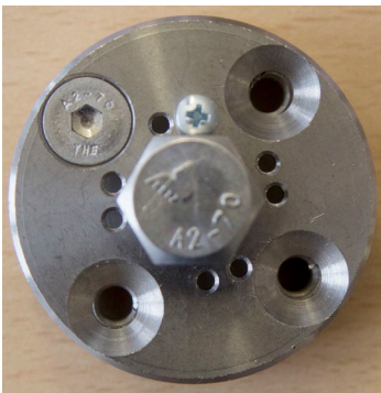
Abb. 3: Kettenkopf mit Sechskantschraube, durch Sicherungsschraube M3, 4 mm gegen Verdrehen gesichert
