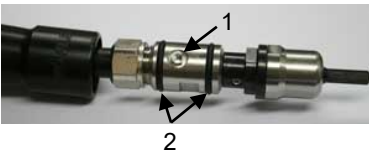
Abb. 7: Schmiernippel unterhalb des Bohrzapfens; der Griff ist hier zurückgeschoben
