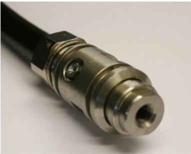
Image 5: Extrémité pour fixer les chaînes et graisseur
