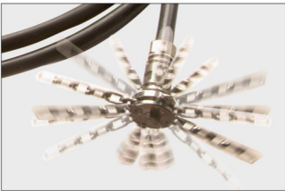
Abb. 5: Kettenkopf durch Bohrmaschine angetrieben
