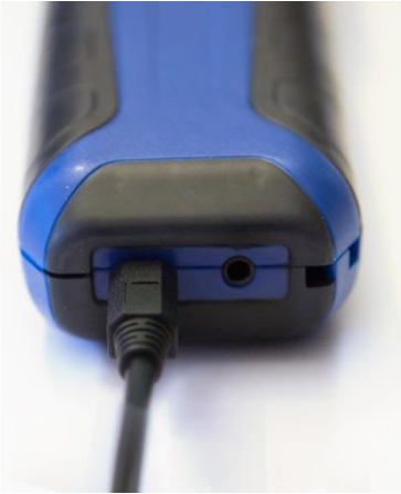
Fig. 23: Partie inférieure de l'appareil, le câble de la balance d'humidité est branché
