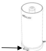
Fig.40: La douille d'étalonnage pour l'organisme de contrôle est marquée par une flèche
