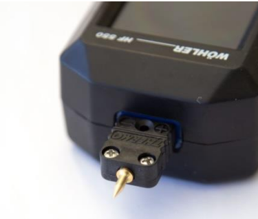
Fig. 12: Partie supérieure de l'appareil, la sonde de température est branchée.
