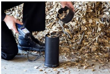
Fig. 26 : Remplir la balance de matériau en vrac
