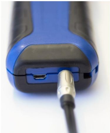
Fig. 13: Partie inférieure de l'appareil, le câble de la sonde marteau est raccordé
