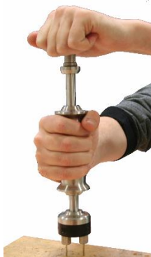
Fig. 16 : Enfoncer la sonde marteau Wöhler
