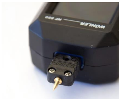
Fig. 22: Partie supérieure de l'appareil, la sonde de température est branchée.
