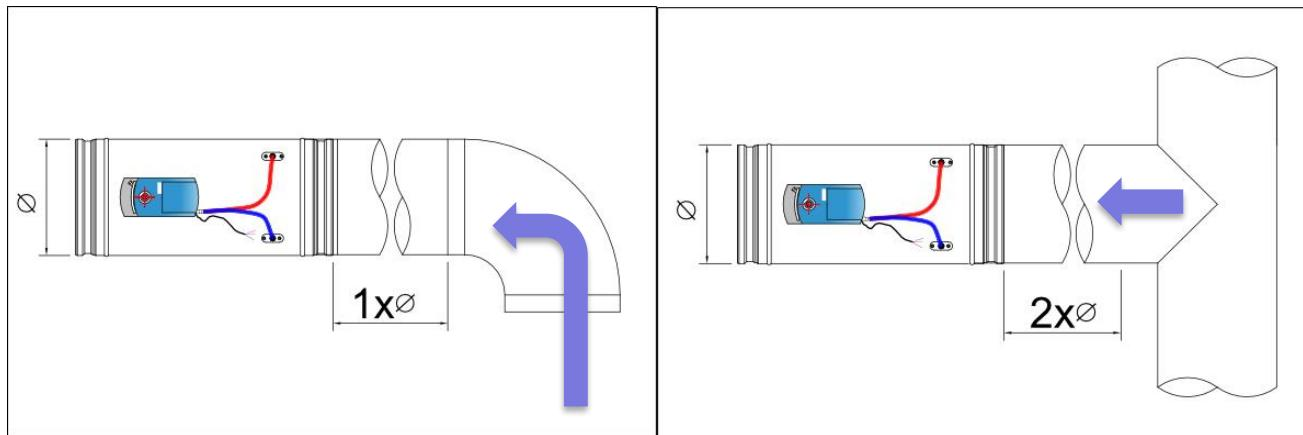
Pour garantir une mesure correcte du débit, un flux d'air uniforme doit être assuré à l'entrée de la sonde de mesure intégrée au régulateur SVA. Si les registres sont installés après un coude, une dérivation ou un autre registre, il est recommandé de respecter les distances minimales indiquées dans le schéma suivant :
