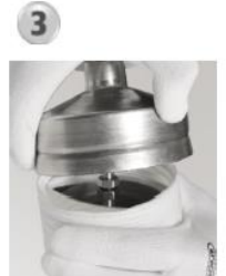
Intégration de l'ellipse dans l'une des spires du flexible
