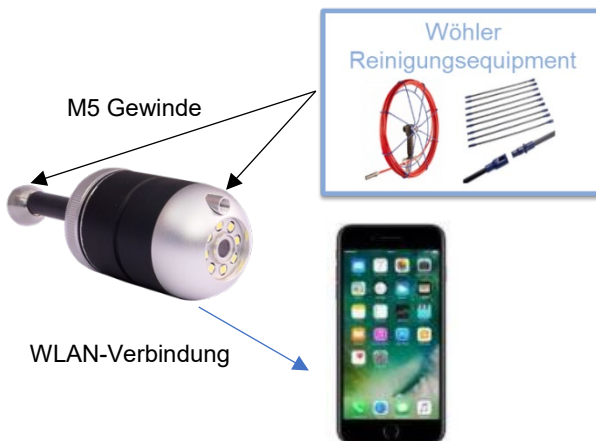
Abb. 1: Funktionsweise Wöhler SI 400
