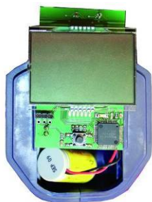
Imm. 45: Remplacement de la pile
