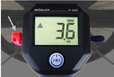
Imm. 53: vite per impostare il freno
