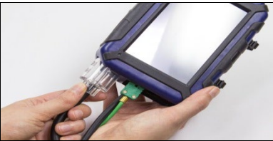
III. 60: Retirer le piège à condensat de l'appareil
