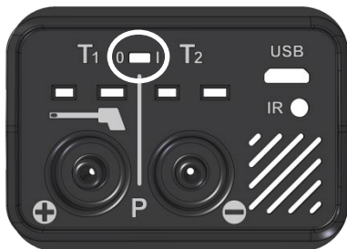
III. 6: Interrupteur de la batterie à droite: Batterie activée Interrupteur de verrouillage à gauche : Batterie verrouillée
