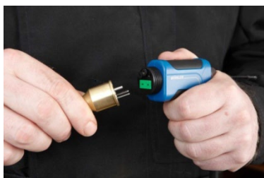
III. 10: Insertion de la sonde enfichable
