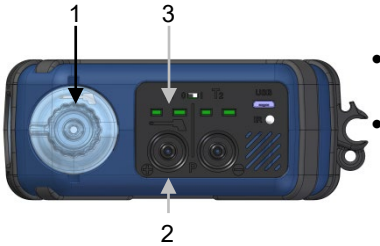
III. 12: Face inférieure de l'analyseur
