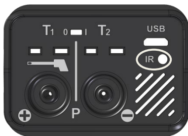
III. 42: Partie inférieure de l'analyseur, interface infrarouge (IR) marquée en blanc.
