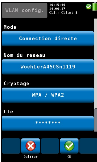
III. 49: Configuration Wifi sur l'analyseur de combustion Wöhler A 450, sélection du mode
