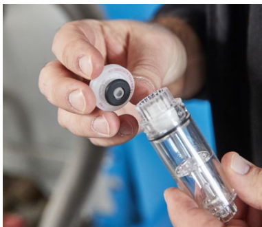
Ill. 64: Le filtre d'arrêt d'eau est inséré sur le porte-filtre
