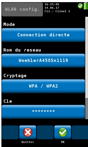
III. 51: Configuration « Connexion directe »
