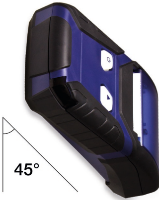
III. 25: Position de l'imprimante pendant la transmission des données de l'analyseur à l'imprimante
