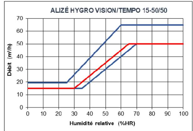
Figure 13 – Caractéristiques hygroaérauliques pour une différence de pression de 80 Pa, modèle ALIZÉ HYGRO VISION ou ALIZÉ HYGRO TEMPO 15-50/50, 30-65 %HR
