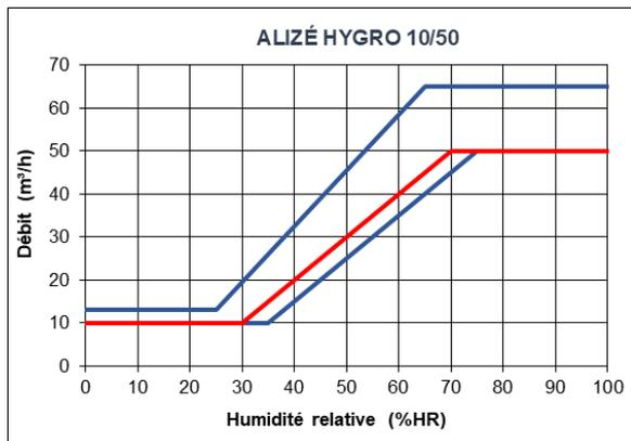
Figure 10 – Caractéristiques hygroaérauliques pour une différence de pression de 80 Pa, modèle ALIZÉ HYGRO 10/50, 30-70 %HR
