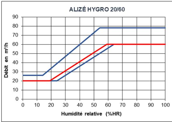
Figure 12 – Caractéristiques hygroaérauliques une différence de pression de 80 Pa, modèle ALIZÉ HYGRO 60, 19-59 %HR
