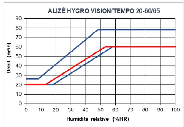
Figure 15 – Caractéristiques hygroaérauliques pour une différence de pression de 80 Pa, modèle ALIZÉ HYGRO VISION ou ALIZÉ HYGRO TEMPO 20-60/65, 13-53 %HR
