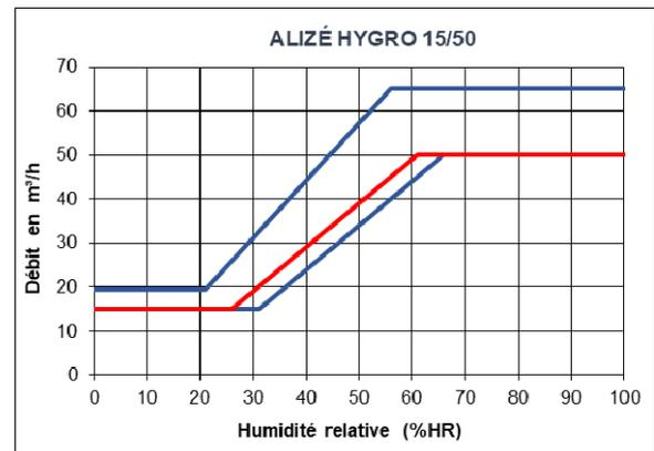
Figure 11 – Caractéristiques hygroaérauliques pour une différence de pression de 80 Pa, modèle ALIZÉ HYGRO 15-50, 26-61 %HR
