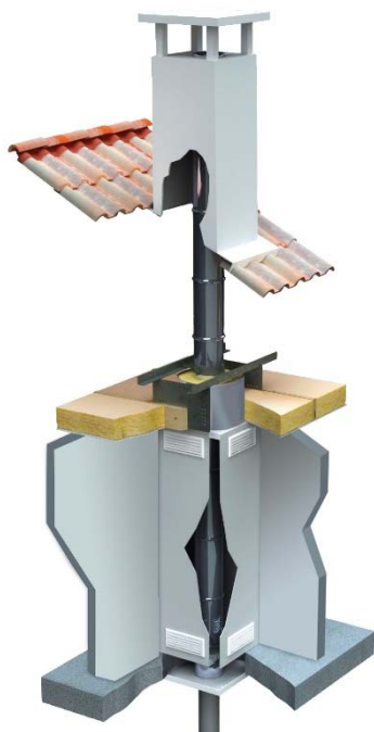
Figure 13A Etage plafond horizontal
