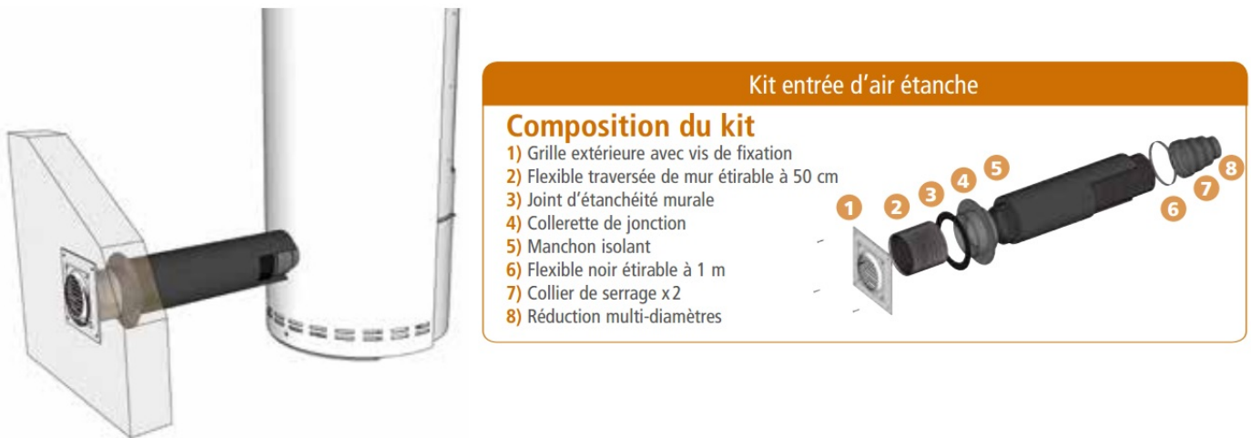
Figure 12 – Kit entrée d'air étanche
