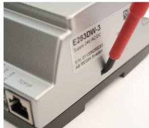
Appuyer sur les clips de chaque côté du boîtier avec un petit tournevis pour desolidariser le couvercle du socle. Maintenez le socle et retirer le couvercle.
