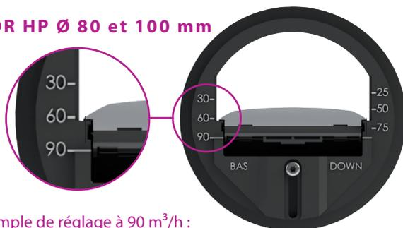
Exemple de réglage à 90 m<sup>3</sup>/h : régulateur calé sur le repère gauche «90»
