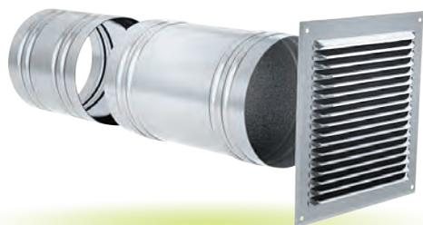
L'ensemble constitué du manchon fixe de 250 mm et du manchon de réglage de 200 mm permet d'assurer la traversée de murs d'épaisseurs 250 à 400 mm.
