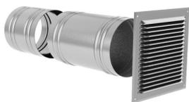
Ensemble constitué : d'un manchon fixe en acier galvanisé longueur 250 mm, d'un manchon réglage en acier galvanisé longueur 200 mm permettant d'assurer la traversée de mur d'épaisseur 250 à 400 mm, d'une grille aluminium à auvents ton naturel venant se clipper sur le manchon côté extérieur - prévoir une légère pente vers l'extérieur et un recouvrement d'au moins 20 mm entre les 2 manchons - disponible du diamètre 100 à 250 mm
