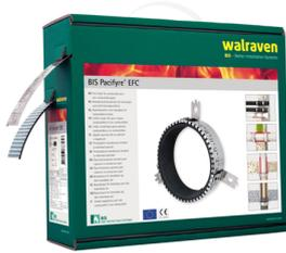
Collier coupe-feu constitué d'une bande intumescente haute performance et d'un collier en acier inoxydable. Des ensembles vis et chevilles sont fournis avec le produit, pour une fixation parfaite au mur ou au plafond. En cas d'incendie, la bande intumescente s'expande et rend le passage paroi étanche au feu et aux fumées.
