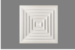
Les diffuseurs carrés de la série DBQ ont été conçus pour combiner l'esthétique avec les exigences techniques des ambiances modernes. Leur géométrie carrée s'adapte parfaitement à l'esthétique des locaux. Ces diffuseurs peuvent être utilisés dans des locaux jusqu'à 4 mètres de hauteur, et un différentiel de température jusqu'à 12°C, en obtenant de bons résultats tant en vitesse de l'air qu'en pression acoustique dans la zone de confort.
