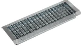
GSCDD : grille Double Déflexion à ailettes verticales sur l'avant et horizontales sur l'arrière – soufflage et reprise d'air
