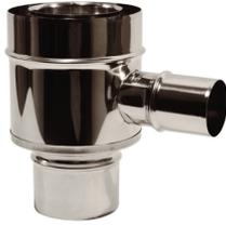
Té 90° concentrique pour évacuation des fumées et amenée d'air comburant, avec piquage prise d'air Ø60 mm et raccordement fumées simple paroi - Bride de sécurité non fournie - Apollo Pellets concentrique - Existe en Ø80/125 et Ø100/150 - Finition inox ou noir mat.
