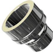
Elément d'adaptation DP/SP femelle Apollo Pellets, permettant la transition entre un conduit Double Paroi isolé Apollo Pellets et un conduit simple paroi femelle Apollo Pellets - Livré avec bride de sécurité - Disponible en Ø 80/140 mm et Ø 100/160 mm - Finition inox.
