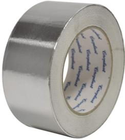
En feuille aluminium pur épaisseur 50 microns avec masse caoutchouc. Très bonne tenue au vieillissement, aux frottements et aux UV. Classement au feu B1 selon DIN 4102. En rouleau de 100 mètres largeur 50 et 75 mm
