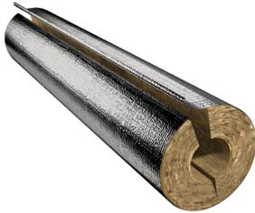
Coquille concentrique en laine de roche pourvue d'une feuille d'aluminium renforcée, fendue sur sa longueur et munie d'une languette autocollante
