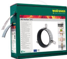
Collier coupe-feu constitué d'une bande intumescente haute performance et d'un collier en acier inoxydable. Des ensembles vis et chevilles sont fournis avec le produit, pour une fixation parfaite au mur ou au plafond. En cas d'incendie, la bande intumescente s'expande et rend le passage paroi étanche au feu et aux fumées.
