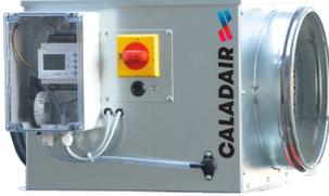
MINIBLUE LOBBY : monté et raccordé d'usine (préprogrammé à 180 Pa) avec coffret de régulation LOBBY monté avec réglage de la pression désirée et afficheur LCD de la pression instantanée.
