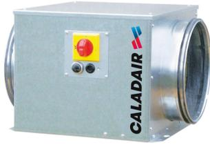
MINIBLUE STANDARD : avec potentiomètre en façade pour réglage du point de fonctionnement. 6 modèles, la gamme MINIBLUE couvre des débits de 50 à 3 600 m<sup>3</sup>/h.
