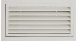
Ailettes horizontales fixes inclinées au pas de 25 mm - Système de fixation par clips non apparents sur plénum ou contre-cadre - Clips permettant également le montage du registre, Modèle porte filtre GRAFPFB (blanc) - grille articulée sur charnière et fixée par 2 aimants - livrée avec filtre démontable – 2 dimensions disponibles de 300 à 1200 m<sup>3</sup>/h.
