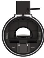
Registre motorisé bi-débites pour la ventilation modulée en tertiaire afin d'obtenir 2 débits d'air constants dans le réseau aéraulique. En position fermée (hors tension), un volet plein équipé d'un régulateur de débit Ø 80 ou 100 mm permet d'obtenir une partie du débit nominal - En position ouverte (sous tension), un régulateur de débit installé en amont du registre règle le débit nominal - Retour en position initiale du volet par l'action d'un ressort et hors tension
