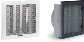
Grille de diffusion d'air chaud réglable avec boîtier intégrant un système de volets orientables permettant de réguler le volume d'air et un piquage circulaire pour raccordement direct sur conduit disponibles en : Modèle 150 x 150 mm piquage de raccordement Ø 100 mm ; Modèle 166 x 166 mm piquage de raccordement Ø 125 mm ; Modèle 191 x 191 mm piquage de raccordement Ø 150 mm.
