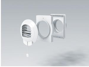
Platine équipée de 2 étriers de largeur 75 mm s'installant une fois les travaux terminés sur des réservations rectangulaires de dimensions (l x h) 80 x 170 à 110 x 245 mm.
