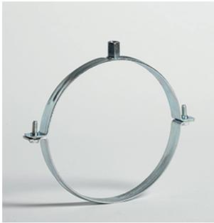
Version nue - Fixation centrale avec écrou double filetage M8/M10 sur tige filetée ou sur pied terrasse (fixation latérale deux points avec tiges filetées M10 préconisée à partir du Ø 450) - Système fermeture rapide sur 1 côté jusqu'au diamètre 400 mm
