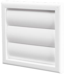
Grille en matière plastique traité anti UV coloris blanc format 155 x 155 mm à ailettes orientables destinée à permettre l'extraction d'air (les ailettes se soulevant par la pression quand l'extracteur est en marche) tout en évitant le retour d'air extérieur quand l'extracteur n'est pas en fonctionnement.
