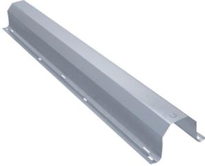
Goulotte de protection en aluminium, d'une longueur d'un mètre permettant de réaliser une protection mécanique efficace pour tuyauterie et câbles émergeant du sol - Possibilité d'emboîtement pour rallonge - Existe en trois dimensions, pour des tubes de maximum Ø 28 mm (conditionnement par 20 pièces), Ø 40 mm (conditionnement par 15 pièces) et Ø 60 mm (conditionnement par 10 pièces).
