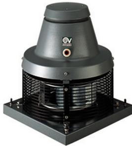
Accélérateur de tirage permettant d'aspirer les fumées chaudes (200° env.) des cheminées à foyer ouvert sur conduit de fumée de section supérieure à 15x15 cm ou Ø supérieur à 180 mm. Moteur à induction monté sur roulement à billes, capable de supporter des températures de service élevées et de longues périodes de fonctionnement.
