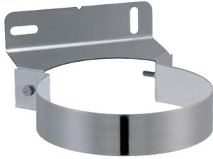
Bride murale réglable sur une plage de 60 à 110mm pour support du conduit flexible isolé VELA. Disponible en Ø80, Ø100, Ø130, Ø150, Ø180, Ø200.
