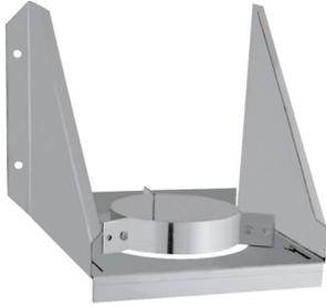
Support mural réglable de 40 mm à 90 mm permettant le maintien du conduit - Apollo Pellets concentrique - A positionner en bas de conduit puis tous les 10 mètres ou après chaque reprise de charge - Existe en Ø 80/125 mm et Ø 100/150 mm - Finition inox.
