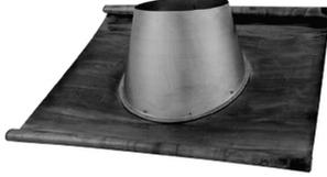
Solin tout plomb peint, permettant de réaliser l'étanchéité entre le chapeau terminal vertical et le toit - Apollo Pellets concentrique - Existe en Ø80/125 mm et Ø100/150 mm - Existe en pente 10/30° et 25/45°.
