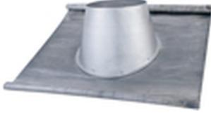
Solin tout plomb, permettant de réaliser l'étanchéité entre le chapeau terminal vertical et le toit. Existe en pente 10/30° et 25/45° - Existe en Ø80/125 mm et Ø100/150 mm - Apollo Pellets concentrique - Finition inox, ardoise, tuile ou noir mat.
