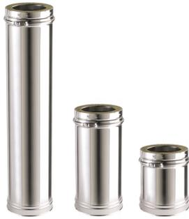
Élément droit pour conduit de fumée double paroi isolé série DPZ - joint monté sur la paroi intérieure – livré avec bride de sécurité – isolant laine minérale épaisseur 30 mm – paroi intérieure inox 316 / paroi extérieure inox 304 – existe en longueurs 330, 500, 1000 & 1250 mm
